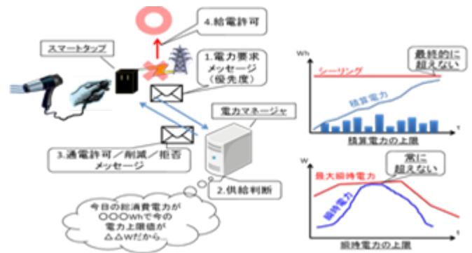
図2 オンデマンド型電力制御システムの基本動作
